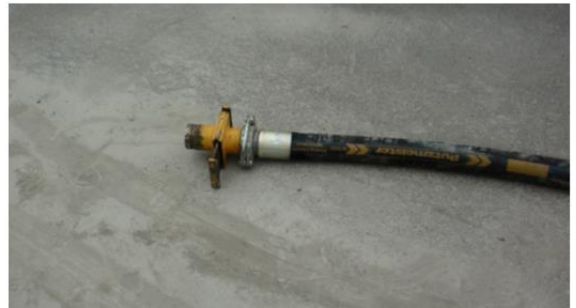
Figur 22 Provgjutning nr 2 där betong trycks in i formens nedre del. Slagventil för anslutning till formen.
